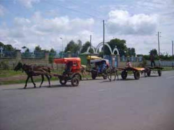
Esistono due tipi di carri: quelli a cavallo per il trasporto di persone, e quelli ad asino (o mulo) per il trasporto di merci. La struttura metallica (fabbricata con pezzi di tubo, cuscinetti e tondini da cemento) si trova in qualunque ferramenta d'Etiopia, sempre della stessa foggia, mentre la parte lignea viene autocostruita dal proprietario.
