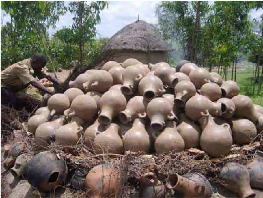
I manufatti in terra, una volta seccati al sole per qualche giorno, vengono accatastati sulle braci ancora calde dalla cottura precedente, in modo da perdere tutta l'umidità residua.
