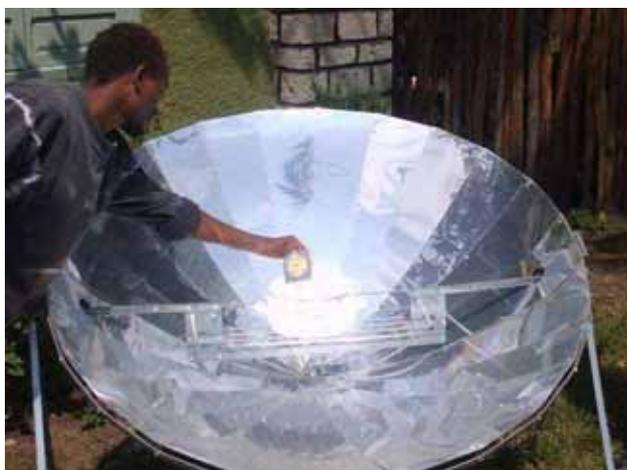
Per "forno solare" si intende un dispositivo passivo in grado di accumulare (nel tempo) o concentrare (nello spazio) il potere calorifico del sole, fino al raggiungimento di temperature utili per la cottura di cibi.
